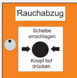
Abbildung 5 | beispielhaft elektrische Handsteuereinrichtung für Rauch- und Wärmeabzüge, Beschriftung „Rauchabzug“, Farbe RAL 2011
